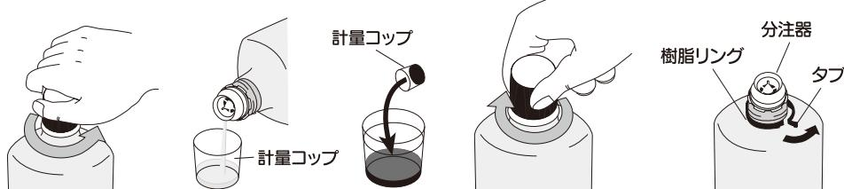
樹脂キャップを矢印(左)の方向に強く廻して開けてください。開栓しますと分注器が装着してあります。
